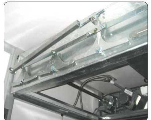
Confiable sistema de volteo requiere 1 o 2 motores, según el modelo
