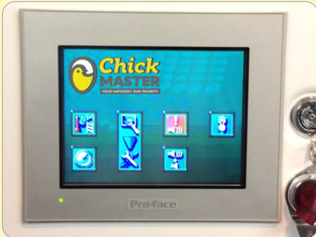
El sistema de control Genesis IV maneja de 2 a 4 zonas, según el modelo
