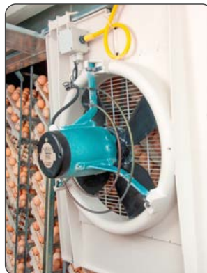
Elementos de calefacción montados en los ventiladores entregan temperatura uniforme
